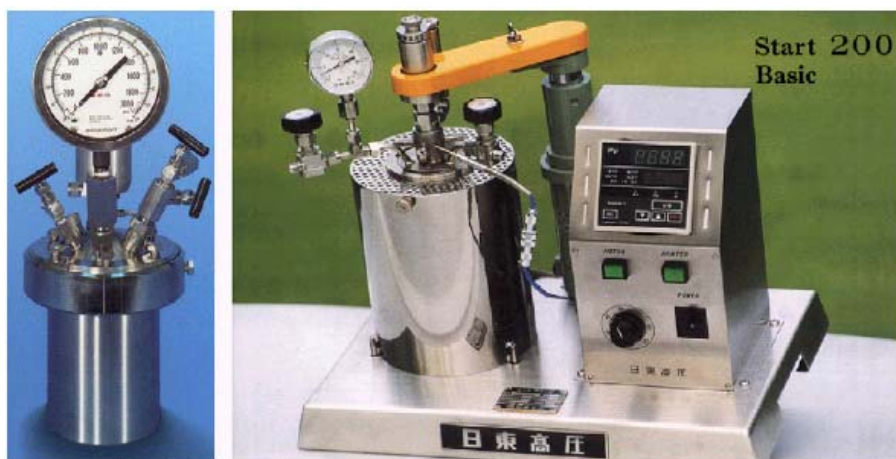
Slika 1.6. Komercijalno dostupni reaktori sa spregnutim magnetnim uređajem za mešanje kod kojih je moguće izvlačenje fluida tokom rada, upumpavanje željenog gasa u autoklav, hlađenje autoklava proticanjem rashladne vode kroz kalem unutar autoklava.
