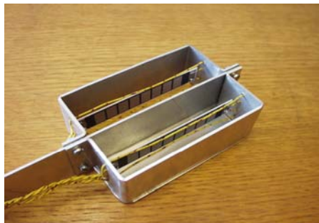
Slika 2.33. Senzor protoka vazduha: ćelija sa dve komore i dva segmentirana NTC termistora postavljena podužno u odnosu na tok vazduha. Gornja komora otvorena za protok, donja poluotvorena (zatvorena sa jedne strane).
