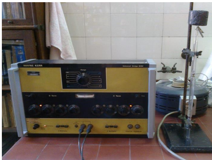
Slika 23. Slika uređaja Wayne Kerr Universal Bridge B224.
