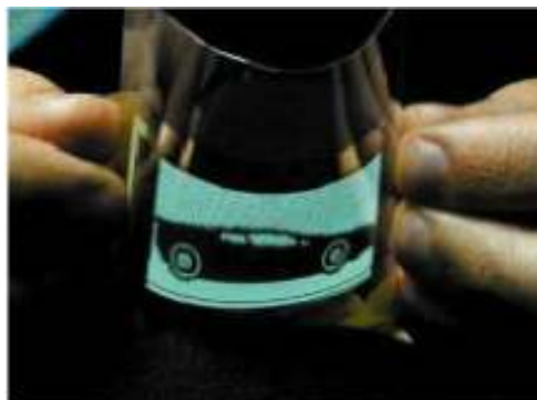
Слика 2.13. Органска пасивна матрица постављена на ПЕТ (полиетилен терефталат) плочици дебљине 1,8 mm.
