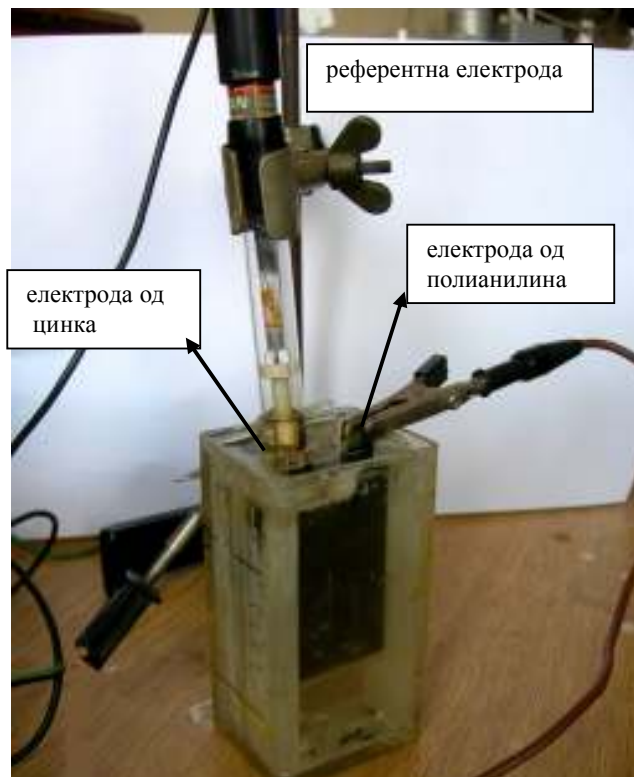
Слика 3.2. Ђелија за испитивање електрода од полианилина и полипирила
