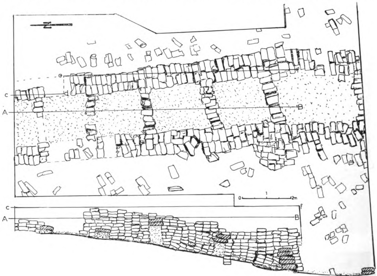
Fig. 7 — Plan et profil du mur, renforcé par des traverses en briques (secteur no. 3)
