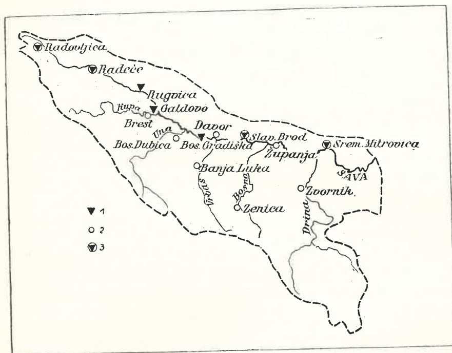
Ск. 14 — Водомерне станице на Сави и притокама са обрађеним водостањем (1), протицајем (2) и водостањем и протицајем (3).
