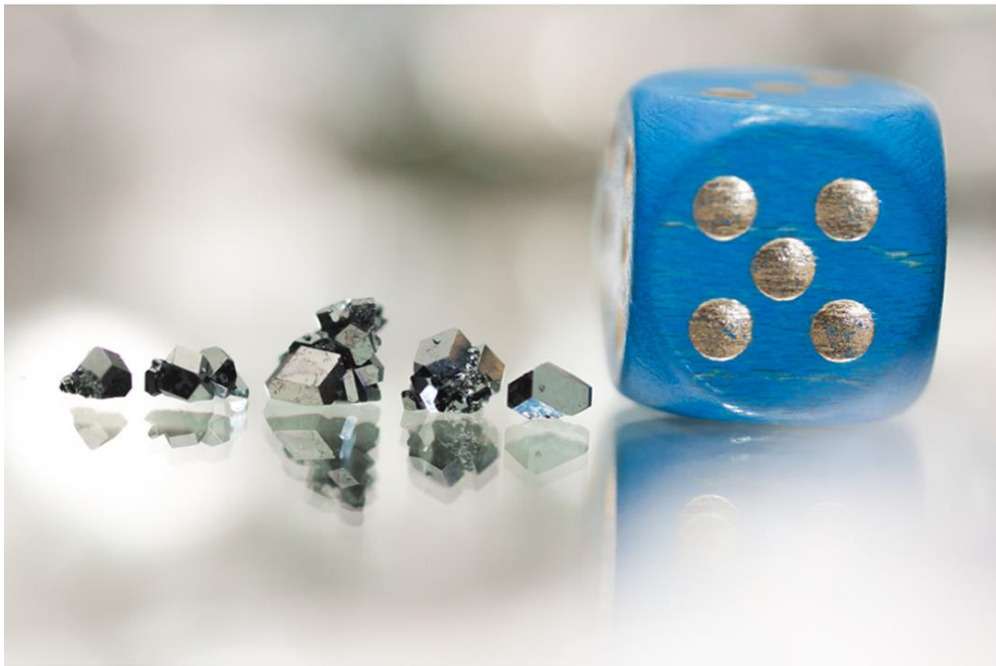
Slika 3.1. Fotografija monokristala \text{CH}_3\text{NH}_3\text{PbI}_3 [178].
