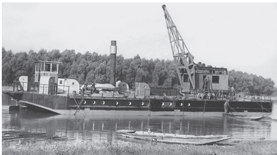
Пловна грабилица са маљем (9,5 t) за разбијање стеновитог речног дна
