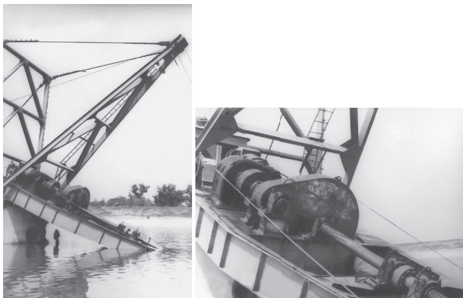
Пловни рефулерни багер „Тиса“ са фрезером, детал лотре и погона фрезера
