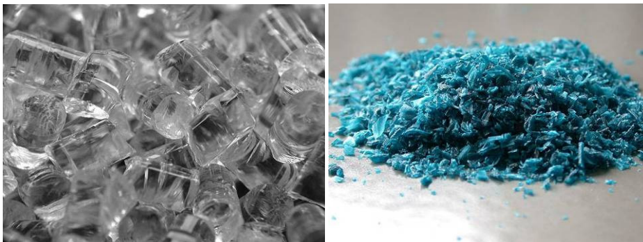
Slika 1.6-1 Komercijalne granule poli(DL-laktid-ko-glikolida) i poli(L-laktid-ko-glikolida)
