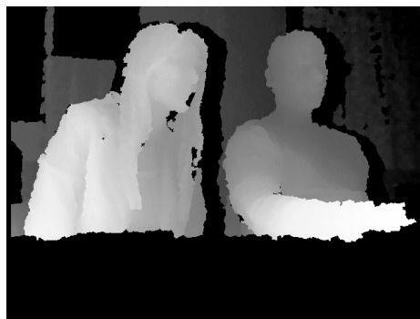
Slika 4. Dubinska slika dobijena procesiranjem IR mape
