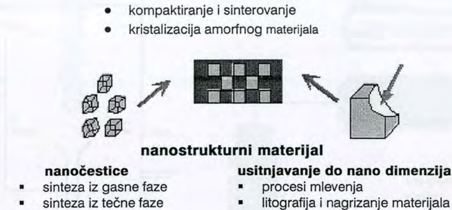
Sl. 4 Šematski prikaz metoda sinteze nanočestica i dobijanje nanostrukturnih materijala
