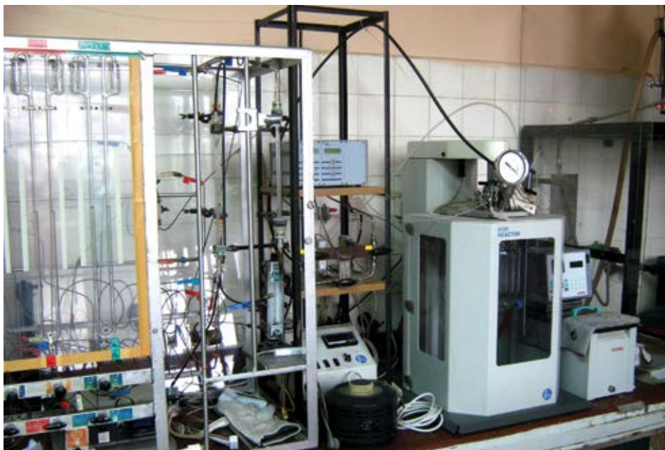
Детаљ из лабораторије ОК-ИХТМ, Београд (реакторски систем за хидрогенацију биљних уља)
