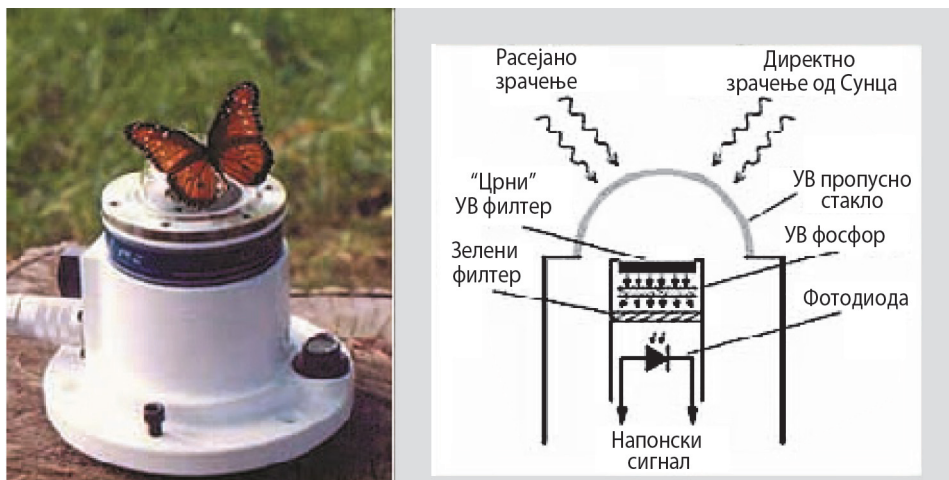
Скица 15. Изглед и шематски блок дијаграм инструмента Yankee UVB1 (извор: Yankee Environmental Systems Inc., 2008; Мијатовић, Чонкић & Миљковић, 2002)
