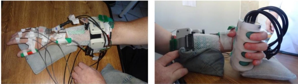
Слика 36 Експериментална поставка за паралелно снимање ЕМГ сигнала и механике покрета: (а) гониометри бележе углове у зглобовима прста приликом њихове флексије и екстензије; (б) динамометар са одвојеним пољима за појединачне прсте бележи силу произведену приликом цилиндричног хвата; по једна матрична електрода 6 \times 4 је постављена на воларну и дорзалну страну подлактице како би се забележили сигнали и са флексора и са екстензора прстију и шаке; свака матрица је повезана на по један „Smarting“ појачавач. Преузето и адаптирано из [5] (Љубазношћу издавача дозвољена је употреба слика у некомерцијалне сврхе)
