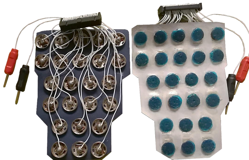
Слика 14 Трапезоидни распоред електрода; 24 SA9327 EKG/EMG Ag-AgCl електроде (Thought Technology Ltd., Montreal, Canada, www.thoughttechnology.com ) распоређене у 5-5-4-4-3-3 распореду. Коришћен је кондуктивни гел AG936 (Axelgaard, Manufacturing Co., Ltd., Denmark, www.axelgaard.com ).
