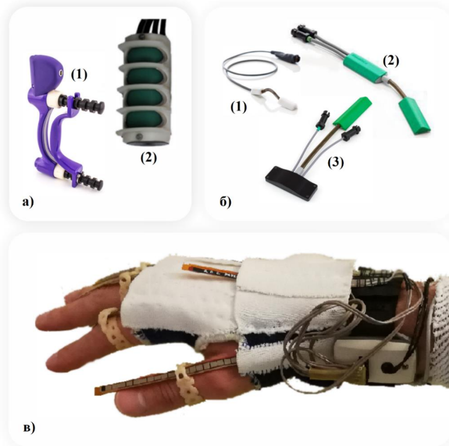
Слика 16 Кинематски и динамички сензори коришћени за естимацију покрета прстима и шаком; (а) динамометар за процену силе хвата за свим прстима „G200“ (1) и са одвојеним сензорима за појединачне прсте (2); (б) гониометри за мерење углова у зглобовима „F35“ (1), „SG65“ (2) и SG110/A (3); (в) рукавица са мерним тракама за детекцију флексије прста
