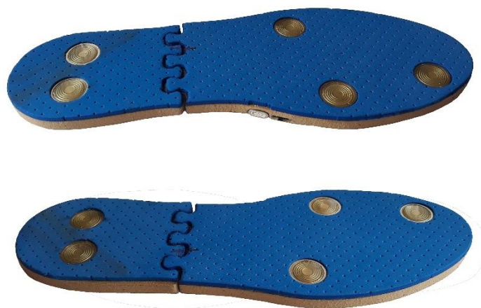
Слика 17 "Gait Tutor" (Rehab Shop, Belgrade, SRB, www.rehabshop.rs ) систем за снимање кинематике и динамике хода - улошци за ципеле са уграђеним сензорима силе и инерцијалним јединицама; повезују се са рачунаром бежино
