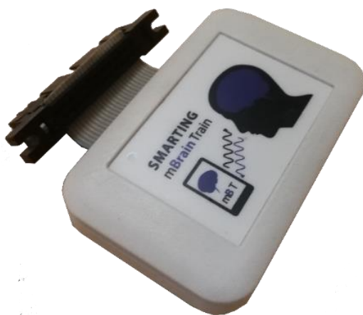
Слика 5 Smarting® појачавач (mBrain Train, Београд, Србија), коришћен у склопу инструментације за мерење. Има 24 канала, фреквенцију одабирања од 500 Hz по каналу и остварује конекцију са рачунаром преко Bluetooth-а.
