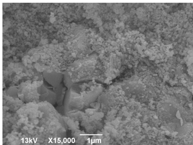
Сл. 2.4.-2 б). наставак: СЕМ микроструктуре узорка BST-S-5 синтерованог изотермски на 1400°C два сата.
