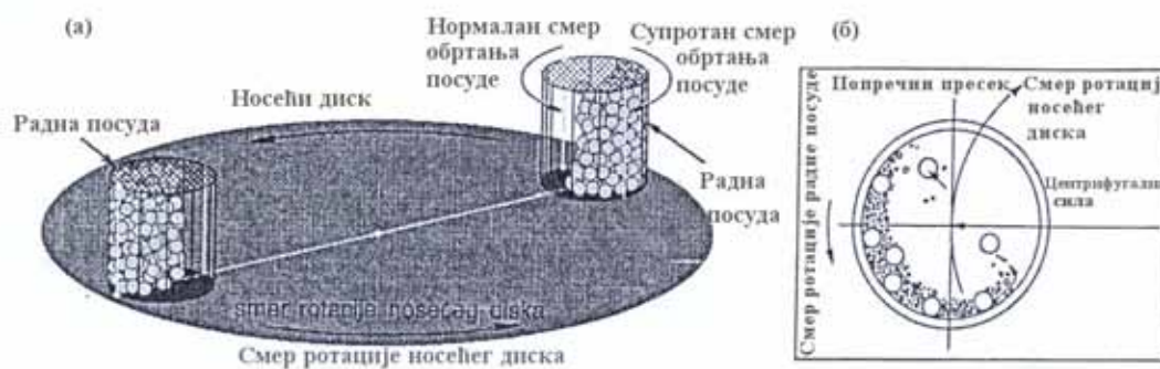
Сл. 1.5.-3. Принцип рада планетарног кугличног млина: у простору (а) и попречни пресек (б) [103].
