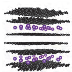
Слика 5. Шема уграђивања алкалних атома између равни решетки графита
