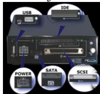
Slika 2. Hardverski blokator upisa Agape SuperDrive Lock 149
