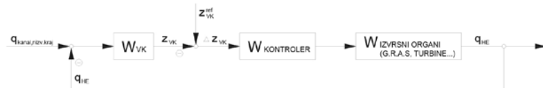
Слика 3. Диспозиција МХЕ са каналском деривацијом типа несаморегулационог канала. Регулација нивоа воде у водној комори
