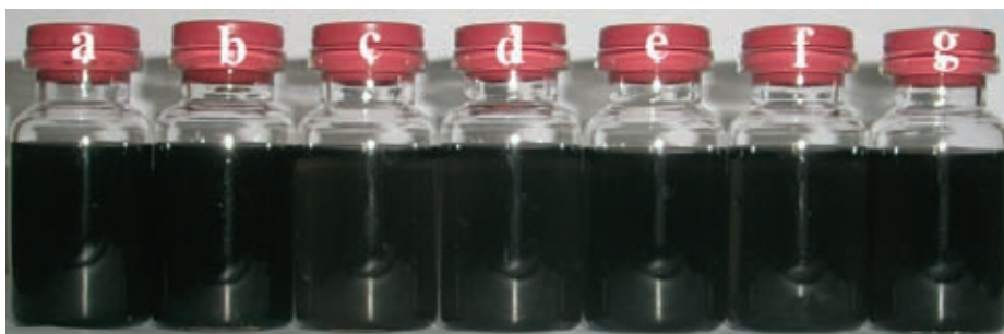
Slika 3.11. Disperzija (a) n-MWCNT, (b) o-MWCNT, (c) e-MWCNT, (d) h-MWCNT, (e) d-MWCNT, (f) t-MWCNT i (g) p-MWCNT u vodi, metanolu, acetonu, i DMF-u, pri koncentraciji od 1 mg/ml. Disperzije su slikane 6 h nakon što su ultrazvučno dispergovane tokom 1 h.
