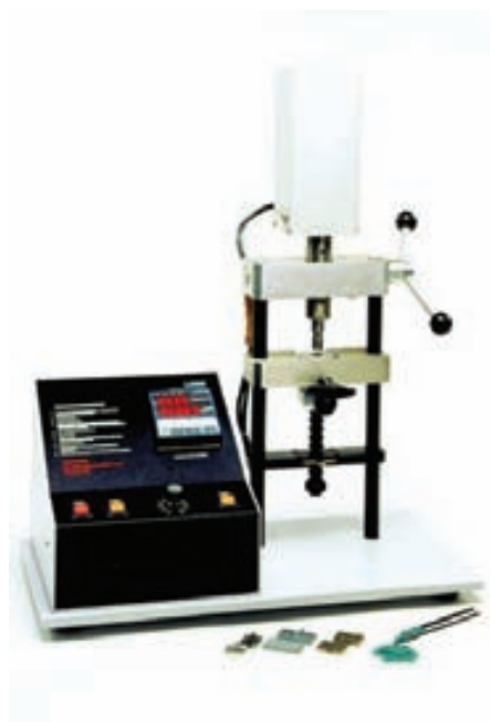
Slika 5.1. Laboratorijski uređaj za mešanje i livenje pod pritiskom.
