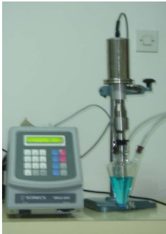
Slika 11. Vibracell sonicator VCX 750 sa reakcionim sudom koji je korišćen za sintezu pomoću sonohemijske reakcije.
