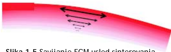
Slika 1.5 Savijanje FGM usled sinterovanja.
