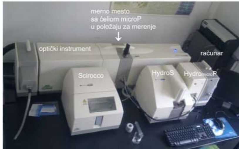
SLIKA 3.2.3 UREĐAJ ZA LD ANALIZU MASTERSIZER 2000, MALVERN INSTRUMENTS, UK: OPTIČKI INSTRUMENT I MERNE ĆELIJE SCIROCCO, HYDROS I HYDROMP [75]
