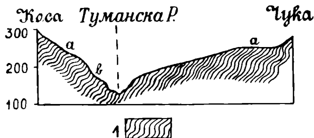
Скица 3 — Профил кроз долину Туманске Реке између Чуке и Косе. 1, кристаласти шкриљци; a, тераса од 110—115 м.; б, тераса од 50—55 м.
