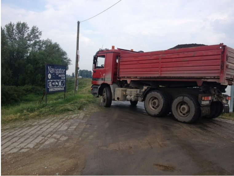
Слика 5. Тешка возила уништавају Савски насип који није димензионисан за саобраћај
