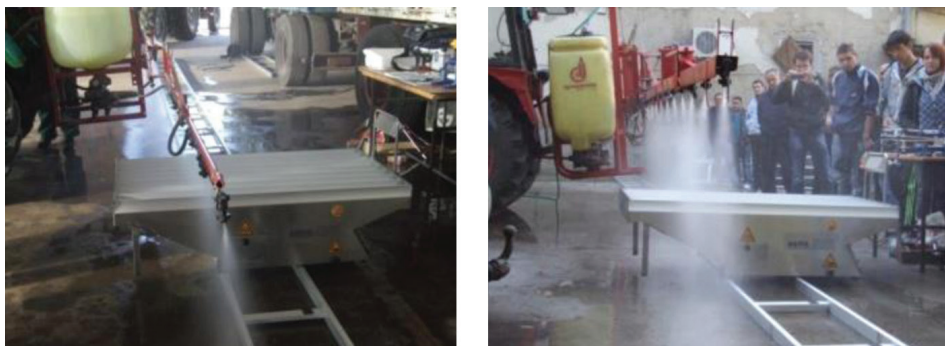
Слика 8. Спреј скенер за контролу попречне дистрибуције (фото: аутор)
