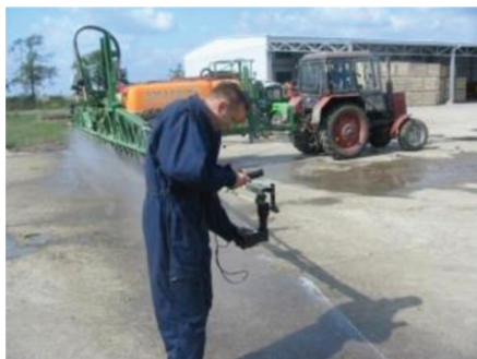
Слика 6. Провера појединачног протока распрскивача (фото: аутор)
