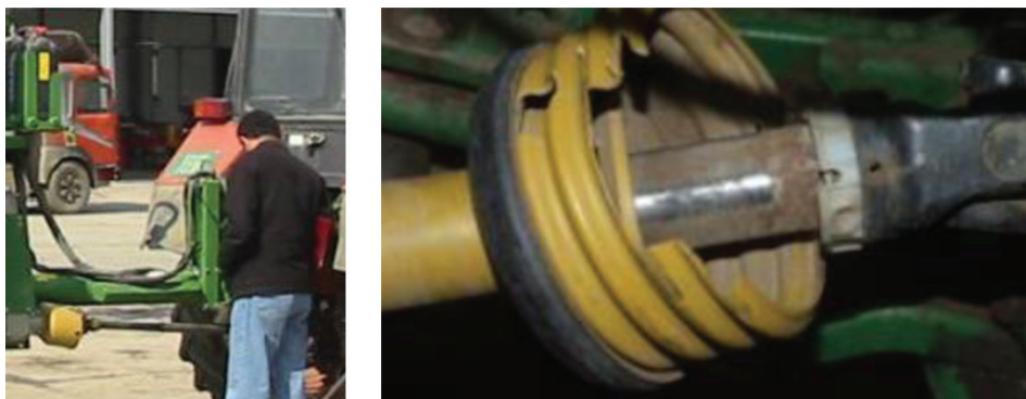
Слика 2. Провера прикључног и карданског вратила (фото: аутор)
