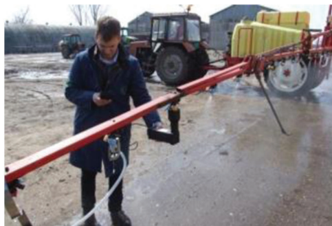
Слика 6. Провера појединачног протока распрскивача (фото: аутор)
