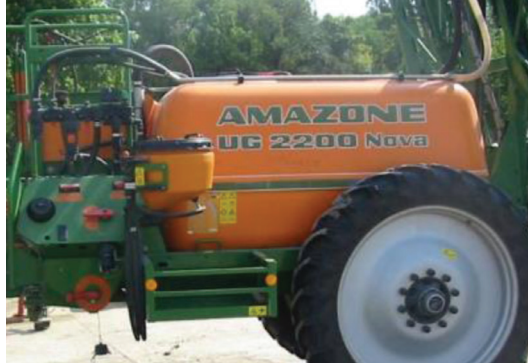
Слика 3. Резервоари прскалице (фото: аутор)
