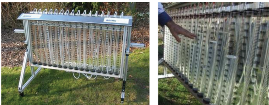
Слика 11. Мерило капацитета већег броја распрскивача (фото: анонимус)
