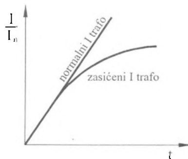
Slika 8. Odnos primarne i sekundarne struje u strujnom transformatoru koji služi za merenje i zaštitu
