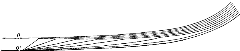
Ск. 8. — Саобразивање уздужног речног профила према спуштеној доњој ерозивној бази (без хоризонталног померања ушћа).
