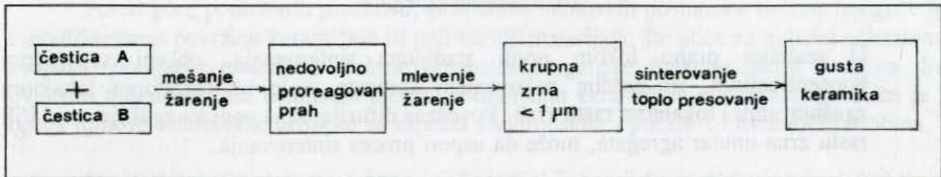
Sl.1.1. Shematski prikaz dobijanja keramičkih materijala konvencionalnim postupkom sinteze (E.Wu i dr., 1984).
