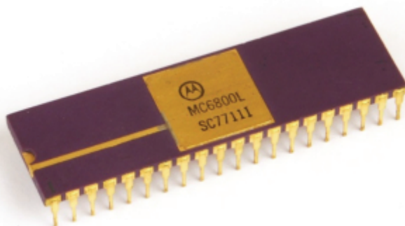
Микропроцесор MC6800 коришћен у управљању тиристорским исправљачима током осамдесетих година 20. века
