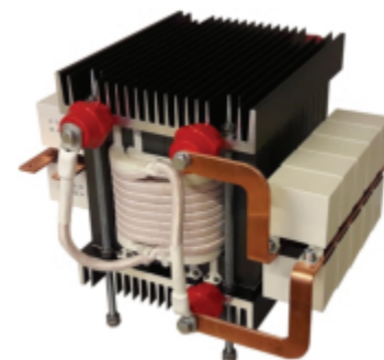
Резултати оптимизације дизајна 100 kW, 10 kHz трансформатора и реализован прототип
