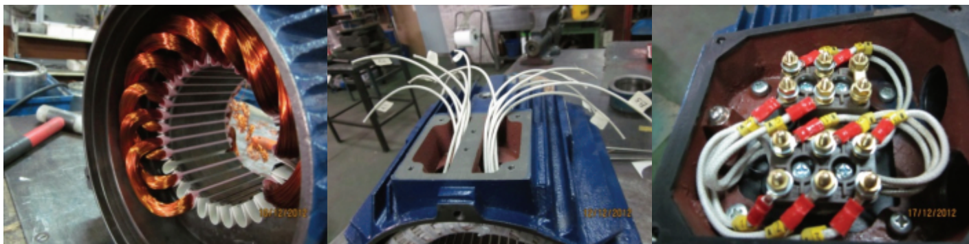
Статор петофазне машине фазни намотаји, крајеви намотаја, прикључци
