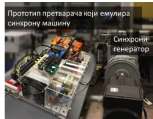
Прототип дигитално контролисаног претварача који емулира синхронну машину (и виртуалну инерцију)
