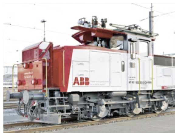
АББ: (лево) 1.2 MW „електронски трансформатор” за локомотиве; (десно) прва локомотива на свету са инсталираним електронским трансформатором.
