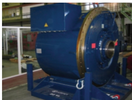
Дванаестофазни генератор за ветрењаче снаге 5 MW, намењен удаљеним фармама ветроелектрана на отвореном мору. Конвертор (десно) садржи четири back-to-back-IGBT модула. (Фотографије добијене захваљујући фирми Gamesa)
